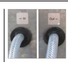
Подключения для инертного газа (например, азота) для промывки
