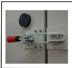
Система безопасности дверей с мощными стяжными зажимами на боковой стороне
