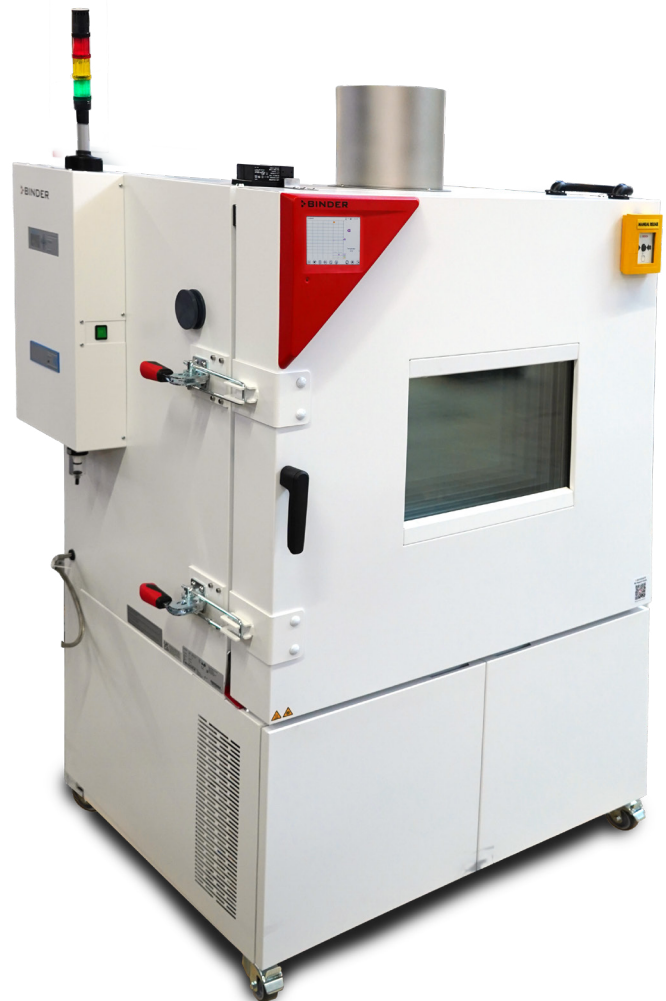
Batterietestschrank mit Paket G
