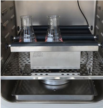
Agitador en la incubadora de CO<sub>2</sub> CB 160 de BINDER
