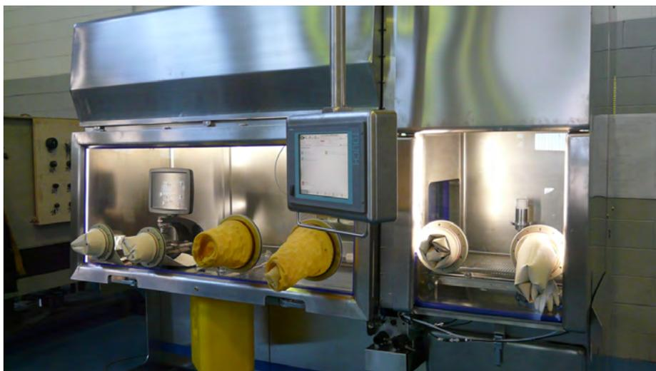
› 1. Módulo de aislamiento con incubadora integrada
