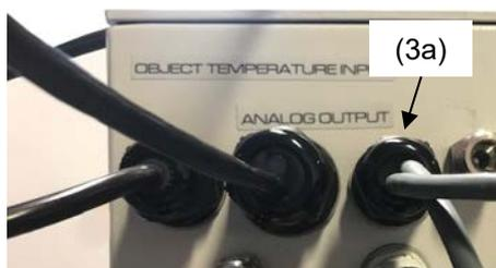
Figura 29: Cable de conexión en la conexión "Object temperature input" (3a)
