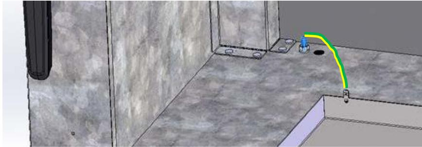
Figura 19: Cable de puesta a tierra para la conexión equipotencial entre la cuba colectora de condensado y el módulo de bomba
