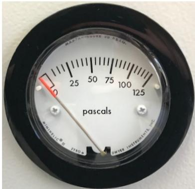
Figura 23: Indicador de presión analógico (manómetro) para la supervisión del lavado de aire comprimido en la parte frontal del equipo
