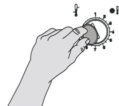
Figura 13: Ajuste del dispositivo de temperatura clase 3.2
