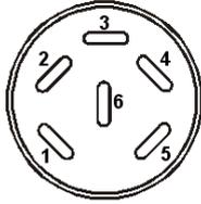
Figura 21: Configuración del pin del conector DIN (6)
