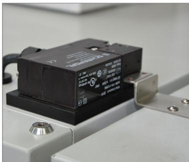
Bloqueo electromecánico de la puerta controlado mediante programa de tiempo o manualmente
