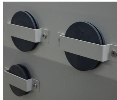
Aseguramiento del puerto de acceso en caso de sobrepresión para unas condiciones de prueba estables
