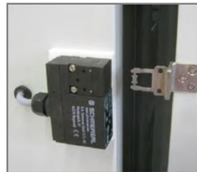
Bloque electromecánico de la puerta controlado por programa y/o manualmente
