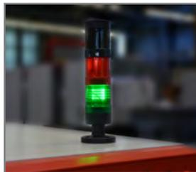
Visualización de la ejecución del programa mediante indicadores luminosos
