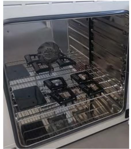
› Las piezas de ensayo son probadas en una cámara de secado de BINDER.
