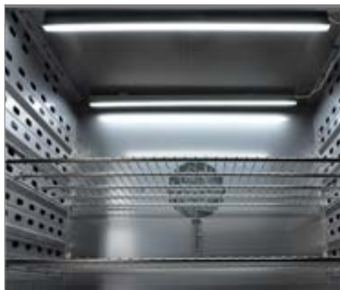
50 cm Lichtleiste, befestigt mit tesa Powerstrips® an der Kesseldecke
