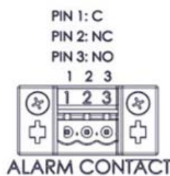
Figura 22: Asignación de pines del conector hembra “ALARM CONTACT” (J) para contacto de alarma libre de potencial
