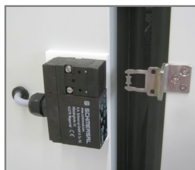
Verrouillage électromécanique de la porte commandé par programme de temporisation ou mode manuel
