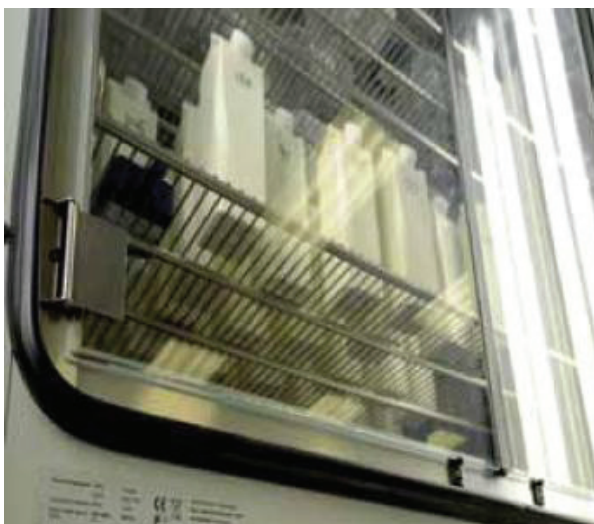
Figure 1 : chambre climatique à conditions constantes (Binder KBF 720) avec une unité d'éclairage montée sur la porte, utilisée par Leatherhead Food Research pour les tests de stabilité des colorants. 3
