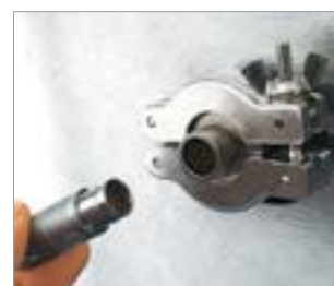
Passage de câble
