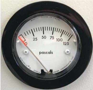
Figure 24: Affichage de la pression analogique (manomètre) pour la surveillance du rinçage à l'air comprimé à la face avant de l'appareil
