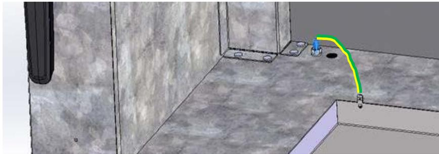
Figure 20: Câble de mise à la terre pour la liaison équipotentielle entre le bac de rétention de condensat et le module de pompe
