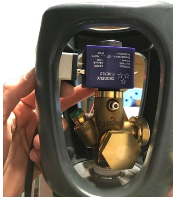
Figure 37: Connexion / déconnexion du connecteur de bobine
