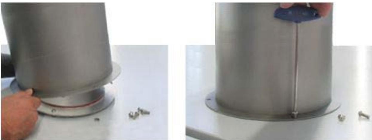
Figure 22 : Montage du raccord d'évacuation d'air en haut de l'appareil
