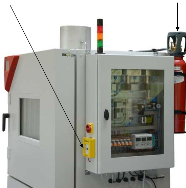
Figure 13: Position des dispositifs de suppression d'incendie au CO<sub>2</sub>
