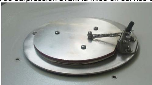
Figure 21 : Clapet de surpression en haut de l'appareil (état de livraison)
