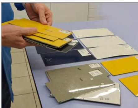
> Retrait des panneaux de test séchés de l'étuve de séchage sécurisée BINDER
