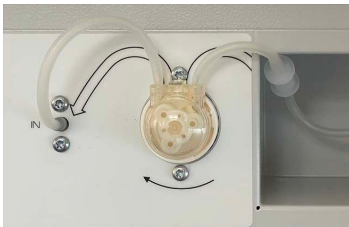
Figure 18: Alimentation en eau par sac d'eau douce, montée
