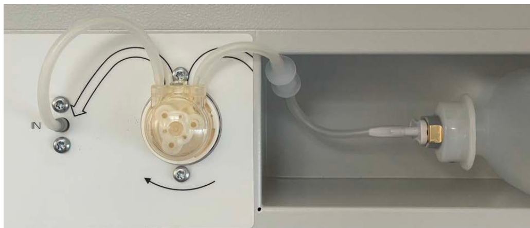
Figure 21: Alimentation en eau par bouteille d'eau remplie, montée
