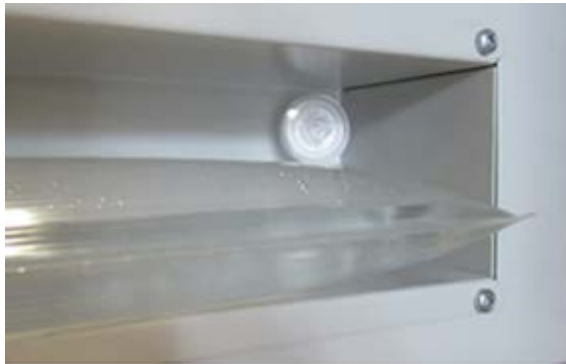
Figure 53: Position du filtre fin à gaz (filtre stérile) dans le recès pour le sac d'eau douce
