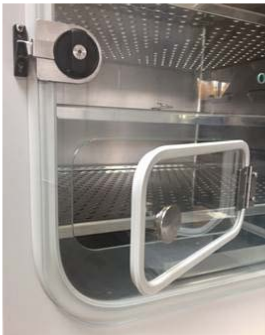
Figure 46: Porte en verre (détail, ex. butée de porte à droite) avec l'option d'accès rapide aux échantillons
