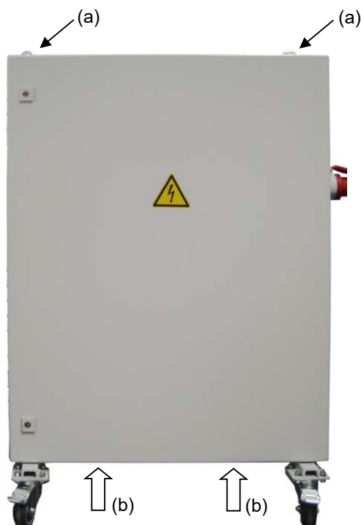
Figure 16: Positionnement d'outils pour le levage du convertisseur de tension et de fréquence
