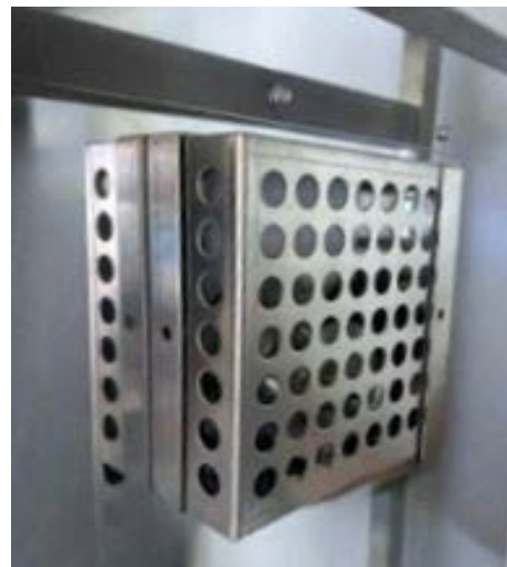
Figure 34 : Montage du boîtier capteur
