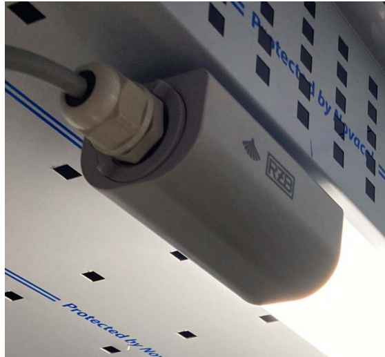
Figure 47 : Position du détecteur de mouvement dans la partie avant de la lampe
