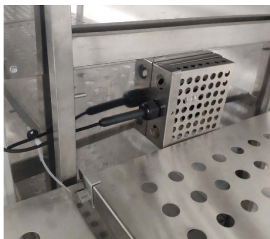
Figure 43 : Capteur de température/d'humidité, monté (position sur le premier déflecteur d'air)
