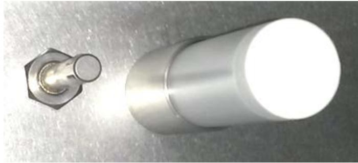
Figure 13: Détecteur de CO 2 (à droite) branché et tête de mélange de gaz CO 2
