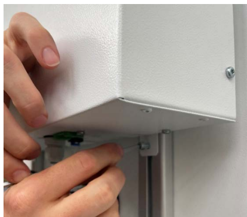
Figure 12: Screwing the ICH Q1B light box
