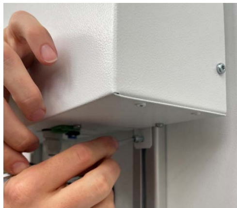
Abb. 3: Festschrauben der ICH-Q1B Lichtbox
