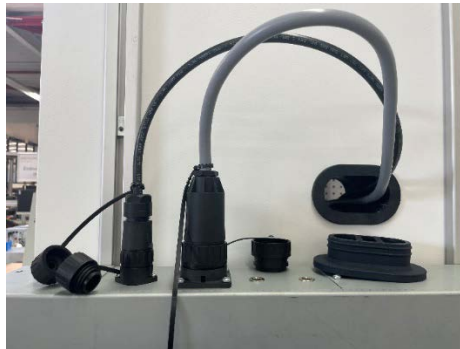
Abb. 5: Anschlüsse der Lichtkassetten an der Oberseite der ICH-Q1B Lichtbox, montiert
