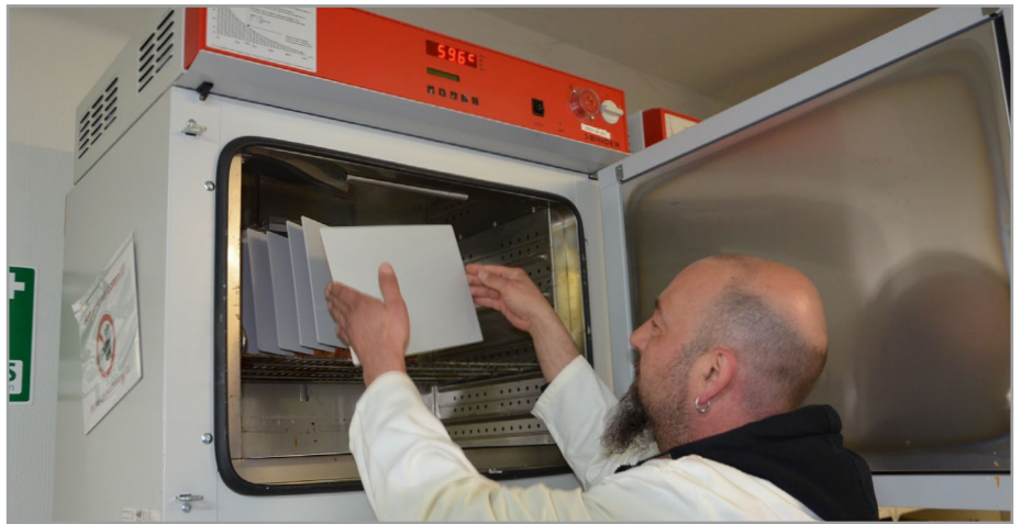
› In nur einer Stunde kann ein Prüfblech mit Lösungsmittellack bei 70 Grad in einem Sicherheitstrockenschrank getrocknet werden.
