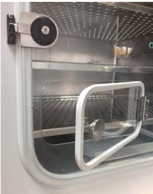
Abbildung 42: Glastür (Ausschnitt, Beispiel Türanschlag rechts) mit Option Proben-Schnellzugriff
