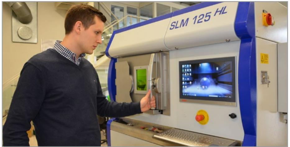
> Mit dem Prinzip des Laserstrahlschmelzens werden Leichtbauteile beispielsweise für die Luft- und Raumfahrtindustrie hergestellt.
