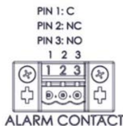
Abbildung 22: Pinbelegung der Buchse „ALARM CONTACT“ (J) für potenzialfreien Alarmkontakt
