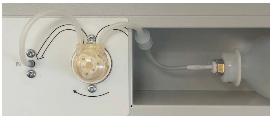
Abbildung 18: Wasserversorgung über Wasserflasche, montiert
