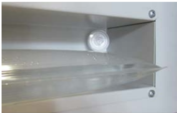
Abbildung 53: Position des Gas-Feinfilters (Sterilfilter) im Ablagefach des Frischwasserbeutels
