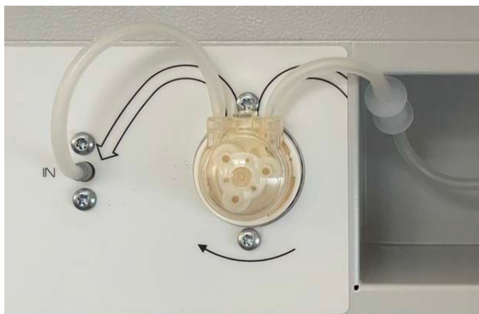
Abbildung 21: Wasserversorgung über Frischwasserbeutel, montiert
