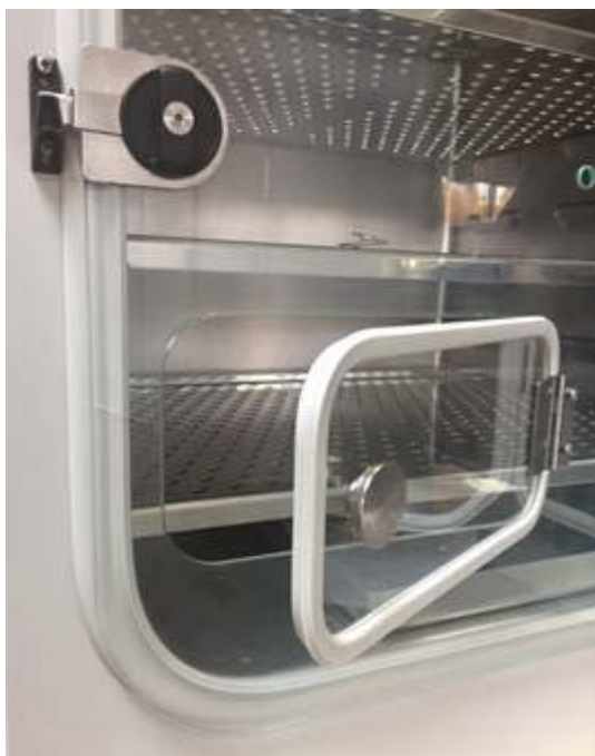
Abbildung 44: Glastür (Ausschnitt, Beispiel Türanschlag rechts) mit Option Proben-Schnellzugriff
