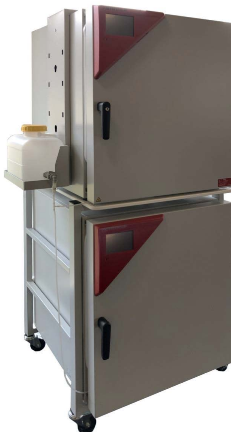
Abbildung 24: Zwei CBF / CBF UL-Geräte mit installierter Wasserversorgung über Frischwasserkarister (Zubehör)
