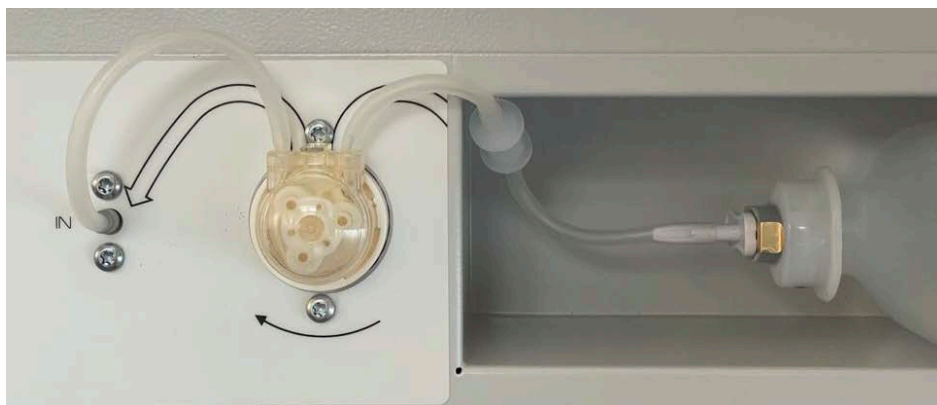
Abbildung 20: Wasserversorgung über Wasserflasche, montiert
