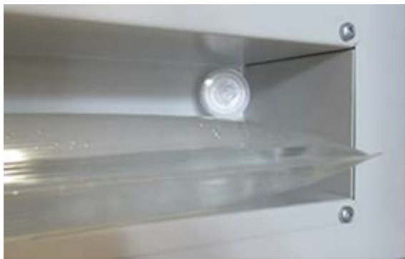
Abbildung 55: Position des Gas-Feinfilters (Sterilfilter) im Ablagefach des Frischwasserbeutels
