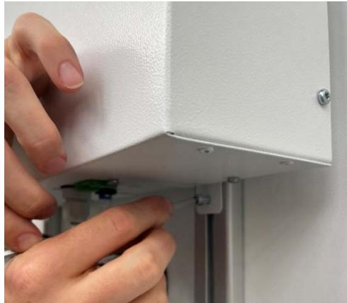
Abbildung 13: Festschrauben der CO<sub>2</sub>-Begasungsbox
