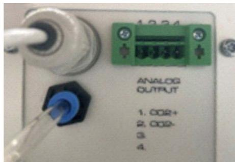
Abbildung 16: Anschluss des CO<sub>2</sub> Schlauchs an der Begasungsbox
