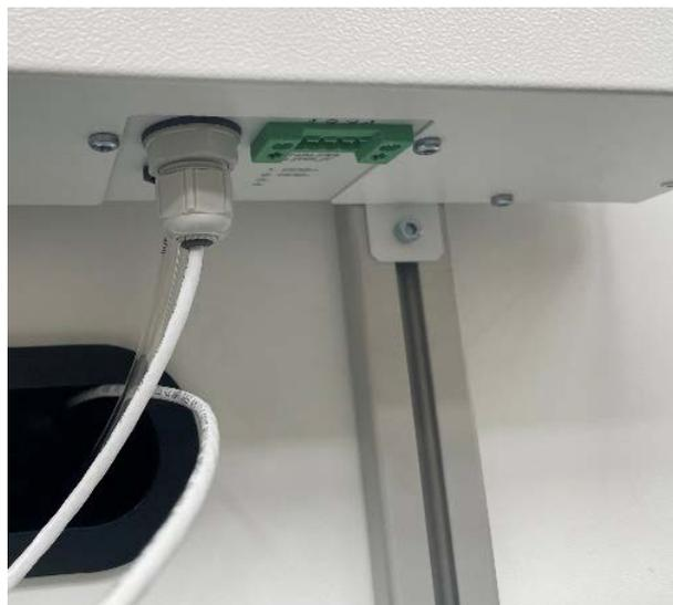
Abbildung 14: Position des CO<sub>2</sub>-Sensor-Kabels mit Kabelverschraubung (9) und Durchführung
