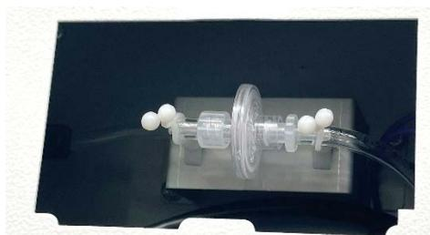
Abbildung 10: Position des Gas-Feinfilters hinter der Abdeckung
