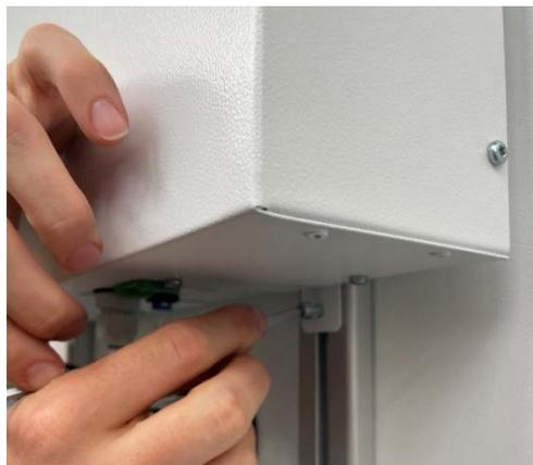
Abbildung 12: Festschrauben der ICH-Q1B Lichtbox
