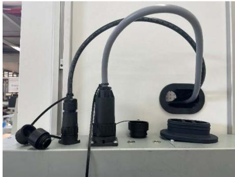
Abbildung 15: Anschlüsse der Lichtkassetten an der Oberseite der ICH-Q1B Lichtbox, montiert
