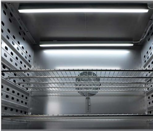
50 cm Lichtleiste, befestigt mit tesa Powerstips® an der Kesseldecke
