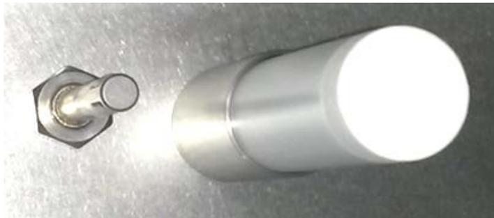
Abb. 11: Eingesteckter CO<sub>2</sub>-Sensor (rechts) und CO<sub>2</sub> Gasmischkopf
