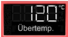
Wenn die Übertemperaturschutzeinrichtung Klasse 1 die Heizung abgeschaltet hat, müssen folgende Schritte durchgeführt werden:
