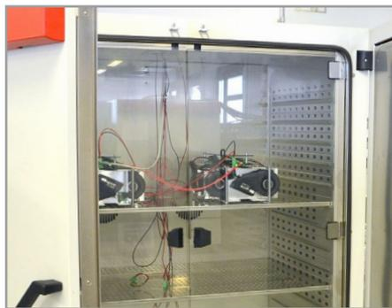
› Stefan Vogtel arbeitet in seinem Messlabor besonders gerne mit BINDER-Wechselklimaschränken. Die Motore werden in den Schrank gelegt und gestresst.
