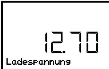
Anzeige der aktuellen Ladespannung der Batterie.
