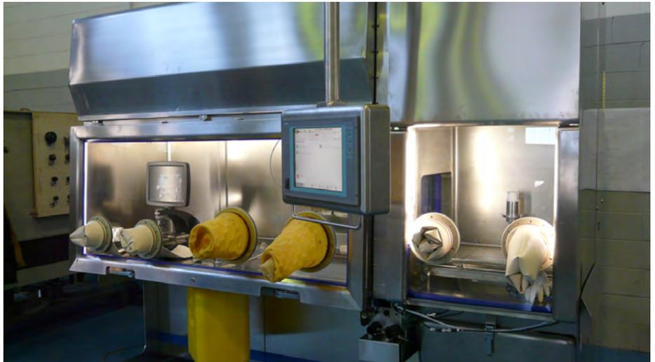
› 1. Isolatormodul mit integriertem Inkubator
