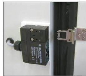
Elektromechanische Türverriegelung gesteuert per Programm und/oder Manuell
