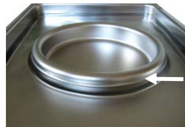
Abbildung 14: Gerätegröße 170 / 260, Füllhöhe der äußeren Wasserschale
