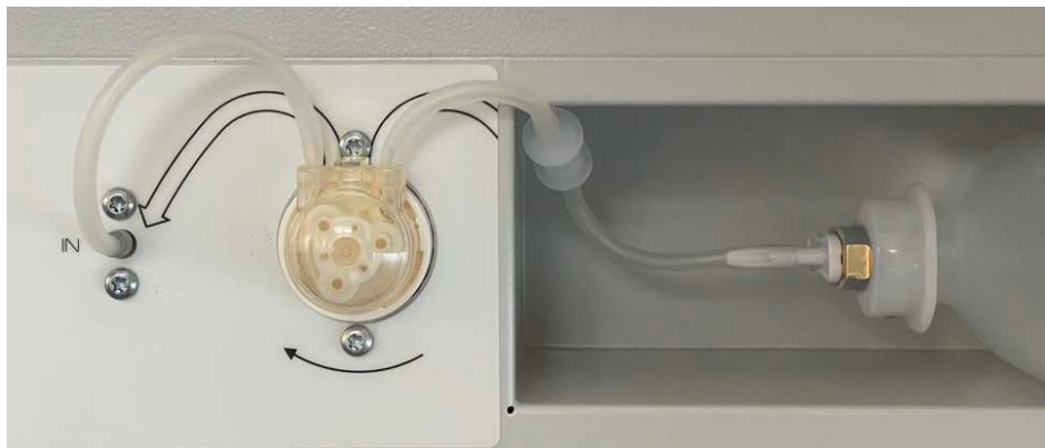
Abbildung 21: Wasserversorgung über Wasserflasche, montiert
