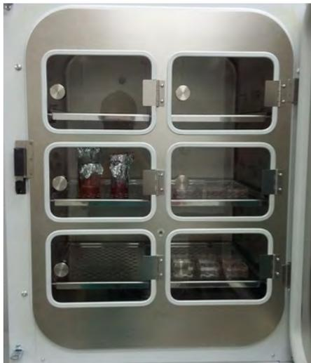
› Die Heißluftsterilisation des CB´s mit getrennten Türen bei 180 °C sorgt für absolute Keimfreiheit
