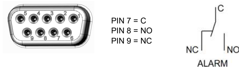
Abb. 14: Pinbelegung der SUB-D Buchse „ALARM / SWITCH CONTACT“ (6) für potenzialfreien Alarmkontakt
